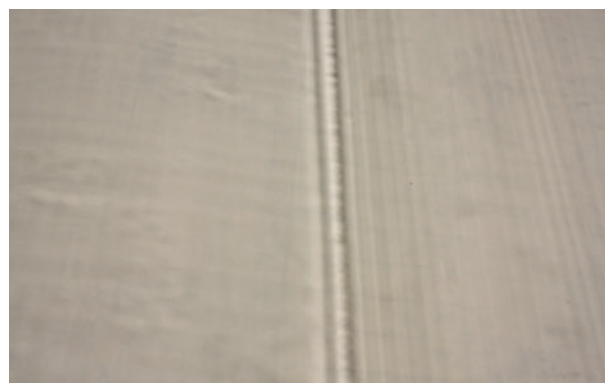
Bild 2. Vergleich des Schattenbilds der Testfolien, die im Chill-Roll-Verfahren (rechte Hälfte mit in Extrusionsrichtung verlaufenden Düsenstreifen) bzw. die mit einem geschlossenen Glättspalt (linke Hälfte ohne Düsenstreifen) hergestellt worden sind (Foto: Groß)
