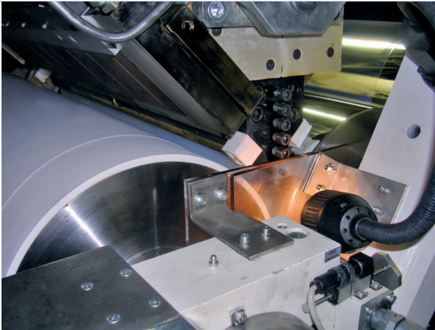
Bild 1. Folienglättwerk mit integrierter gummierter Glättwalze (Foto: KraussMaffei Berstorff)
