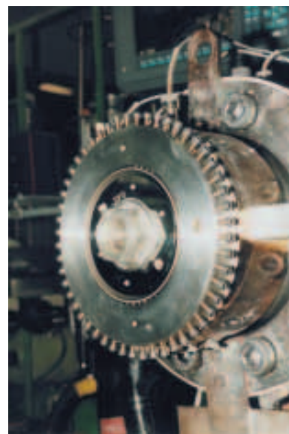
Bild 2. Flexringwerkzeug angeflanscht an einen Rohrextruder kurz vor dem Anlagenstart
