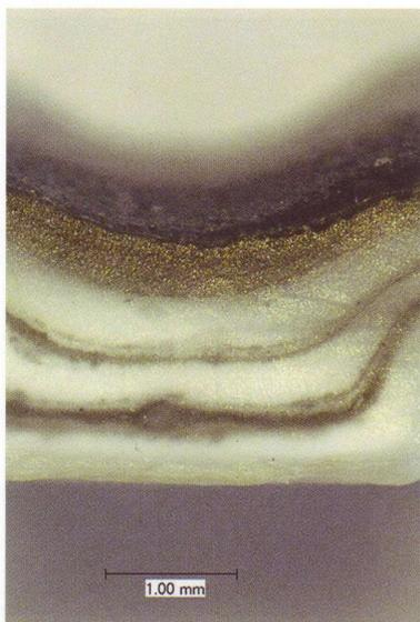
Рис. 2. На сделанном под микроскопом снимке поперечного сечения области соединительного шва формованной детали видно, что в новой смесительной зоне раздувной головки расплав делится на несколько слоев, которые в стенке детали накладываются друг на друга, и границы между ними исчезают (фото: MPA/IFW, TU Darmstadt)
