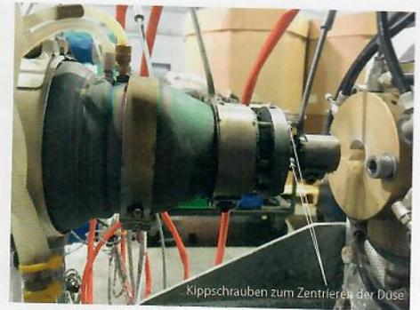
**Bild 4.** Schlauchkopf mit Kippdüse und axial angeordneten Stellschrauben während der Erprobung bei der Siro-Plast GmbH (© H. Groß)
