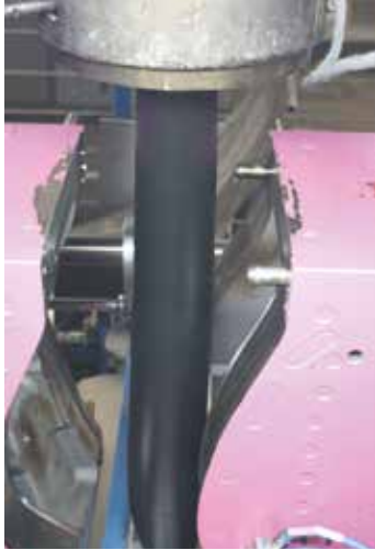
Bild 5. Gerader, wellenfreier Vorformling (links) mit einem großen Wanddickenunterschied (rechts), der aus einer GWDS-Düse mit einem extrem profilierten Dorn (Mitte ausgetragen wurde) (© H. Groß)
