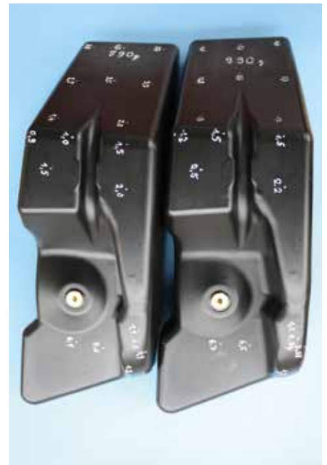
Bild 6. Gewicht und Dickenverteilungen eines mit einer GWDS-Düse (links) und eines konventionell (rechts) hergestellten Waschwasserbehälters (© H. Groß)
