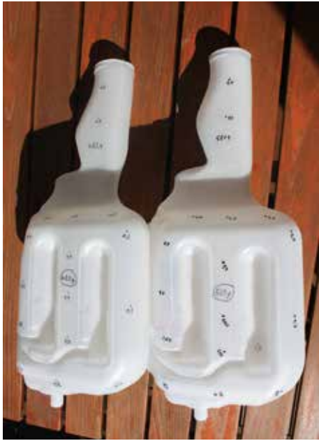
Bild 2. Scheibenwaschwasserbehälter: Durch GWDS-Technik (links) mit optimierter Wanddickenverteilung hergestellt wiegt er 482 g, konventionell produziert dagegen 560 g (rechts) (© H. Groß)
