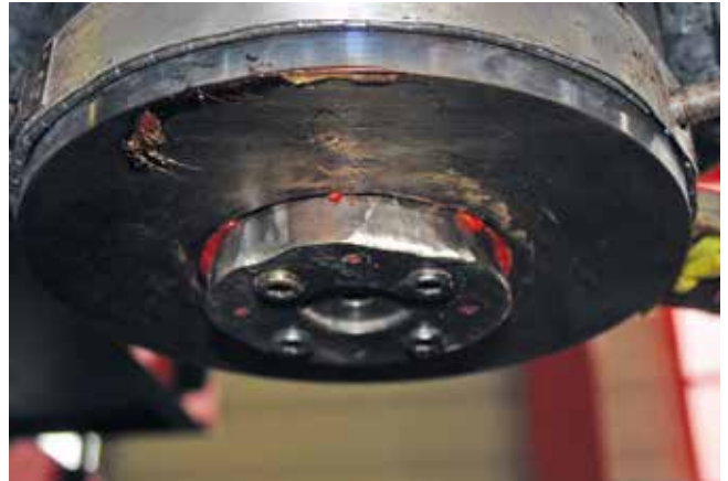
Bild 4. Dornsituation, bei der die Schmelzestromverteilung des Vorformlings nicht durch die extreme Profilierung am Dornende beeinflusst wird, da sich die Profilierung außerhalb des Fließkanals befindet (Bild: BIG)
