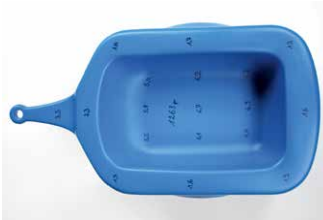
Bild 1. Gewicht und Waddickenverteilung (Dickenwerte in mm) der Oberseite des mit einer konventionellen konischen Düse gefertigten Anhängers (Bild: Groß)
