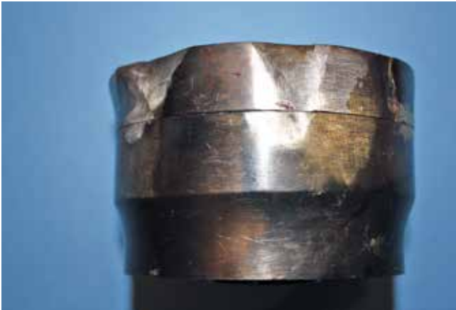
Bild 3. GWDS-Dorn, der im Endbereich in extremer Weise von Hand profiliert worden ist, um die Wanddickenverteilung im Bereich der Ladefläche des Anhängers zu verbessern (Bild: BIG)
