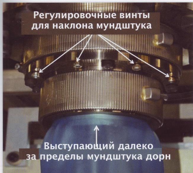
Рис. 2: GWDS-мундштук с просматриваемым внутри заготовки дорном
