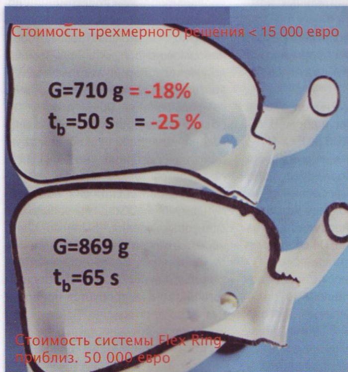
Рис. 4: Топливная канистра, изготовленная по стандартной технологии (снизу) и по трехмерной технологии (сверху) [G = масса канистры; t_b = время раздува или охлаждения]
