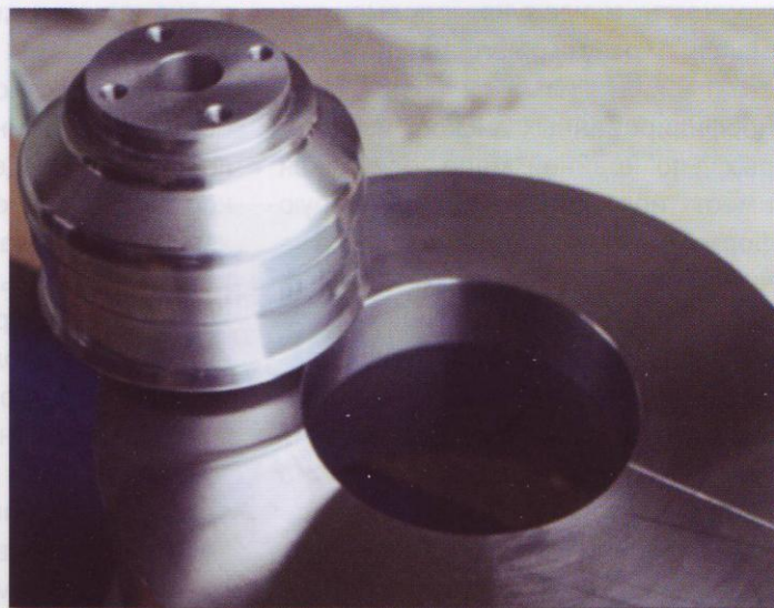
Рис. 3: Объемный формующий инструмент: выходная область мундштука имеет цилиндрическую форму, а дорн состоит из отдельных дисков со сложной трехмерной геометрией
