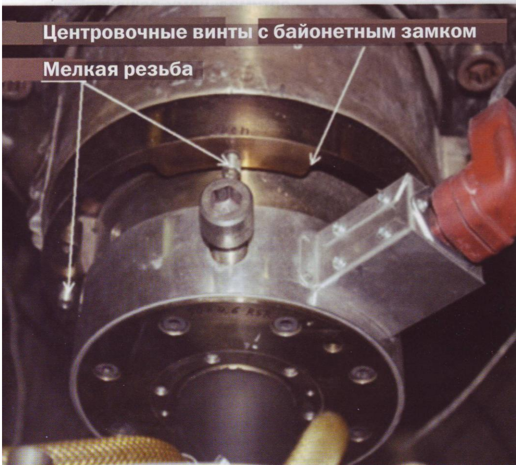
Рис. 2: Трубная головка, мундштук которой крепится при помощи байонетного затвора; для перемещения мундштука предусмотрено два специальных винта с мелкой резьбой с шагом 0,5 мм
