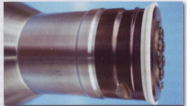
Рис. 5: Трехмерный дорн, использованный для изготовления топливной канистры, показанной на рис. 4
