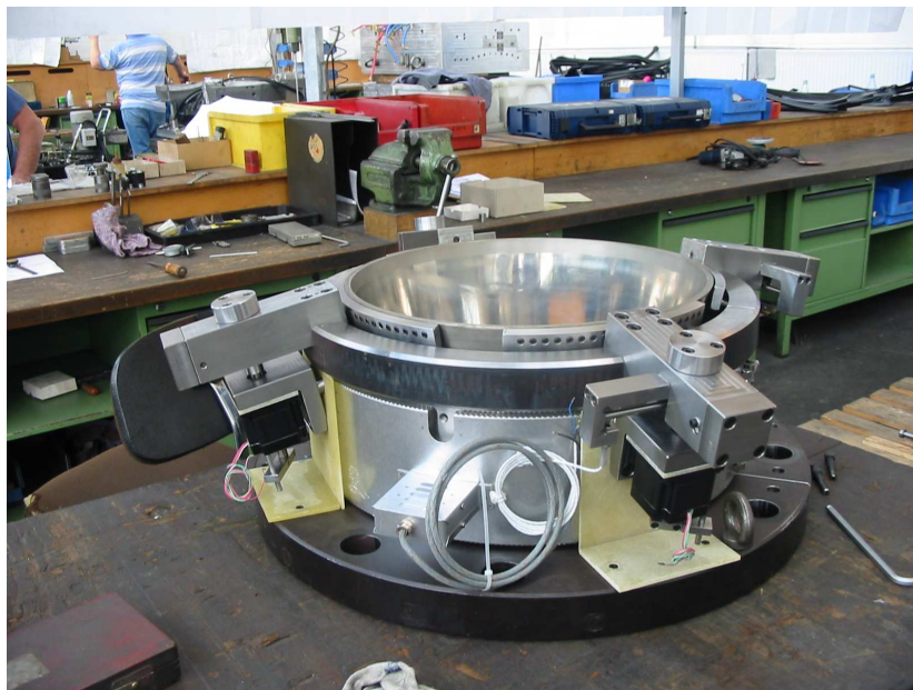
Bild 2 Flexringwerkzeug zur Herstellung eines IBC mit vier Stellbacken, in denen jeweils Madenschrauben sitzen, um eine Feinoptimierung des Fließkanalspalts vornehmen zu können
