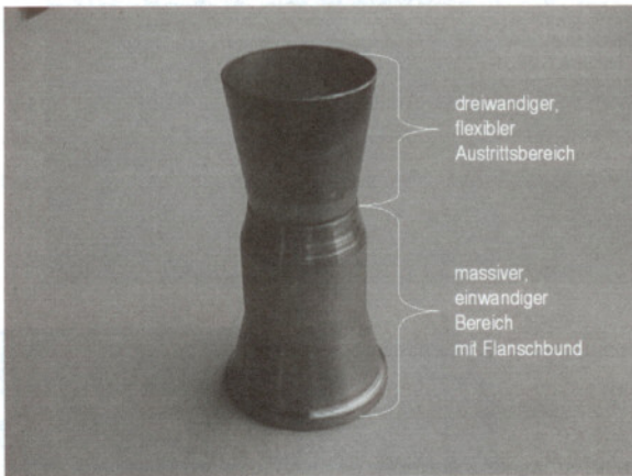
Bild 1 Im dreiwandigen divergenten Austrittsbereich flexibel deformierbare Flexringhülse mit einem Austrittsdurchmesser von 33 mm
