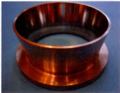
**Bild 2. Einteilige Flexringhülse mit einem Durchmesser von 130 mm, bei der sich die 15 Einzelwände im flexibel deformierbaren konischen Bereich gegeneinander abstützen**
