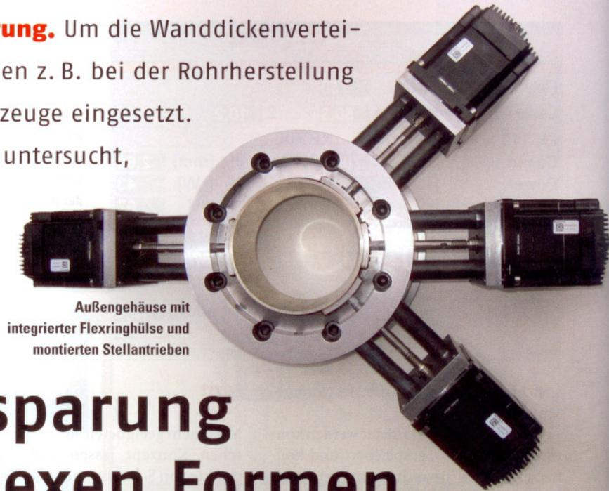
Außengehäuse mit integrierter Flexringhülse und montierten Stellantrieben
