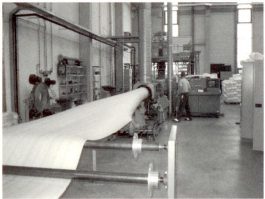
図14 フレックスリングダイを用いた発泡シートの成形ライン
