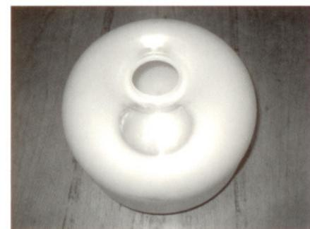
図17 極端な薄肉部を有する押出ブロー成形品例：流路を部分的に絞ってみせた実験例
