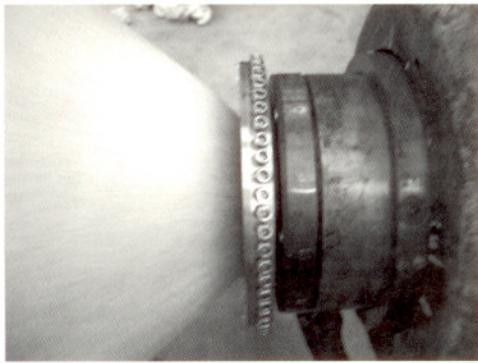
図13 発泡ポリオレフィンシートを成形するためのフレックスリングダイ：流路形状を高精度で制御するために出口付近に60個の調整ボルト（M6）を付属させている
