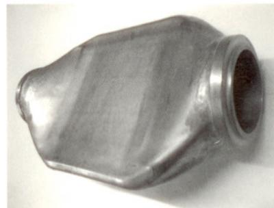
図8 中央流路調節部品：両端を厚肉のフランジで固定し、中間部は変形しやすい20枚の薄い隔壁板で構成されている
