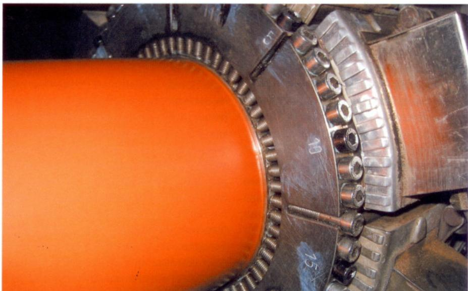
дает внушительной линейной эластичной деформационной способностью. Вскоре ею будет дополнительно оснащен выдувной инструмент линии по производству больших емкостей. С помощью четырех электрических линейных приводов выходная щель динамично регулируется при каждом цикле в соответствии с объемом инструмента, чтобы соблюсти соотношения вытяжки в различных местахируемой емкости. Таким образом, распределение
