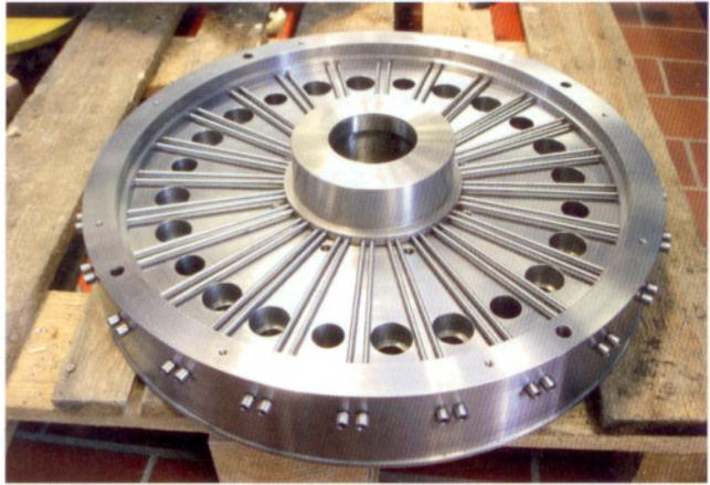
**Bild 4.** Aus einem Stück bestehende Coextrusionsscheibe mit integrierter partiell mehrwandiger Fließkanalwand und radial angeordneten Stellschrauben zur Feineinstellung des lokalen Fließkanalspalts im Bereich, in dem Mittel- und Innenschicht zusammenströmen
