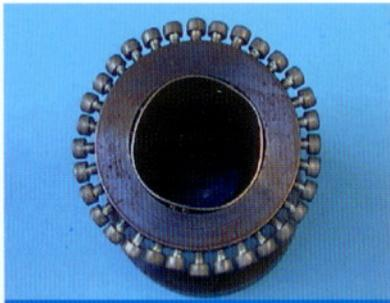
Bild 3: Demonstration des enormen Deformationsvermögens einer Flexringhülse am Beispiel eines Werkzeugs mit einem Durchmesser von 43 mm
