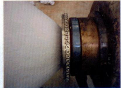
Bild 10: Flexringwerkzeug (ø 120 mm) mit 60 Stellschrauben zur Optimierung der Schaumdicke über der Breite der hergestellten Platte
