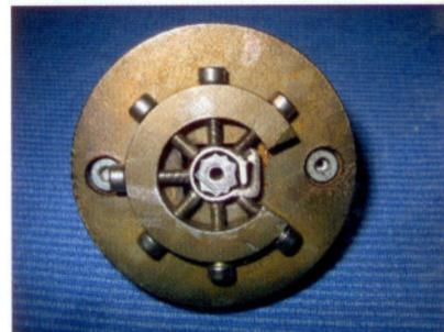
Bild 15: Versuchswerkzeug mit bereichsweise verstellbarem Austrittsspalt zur Herstellung eines Dichtprofils aus Silikon
