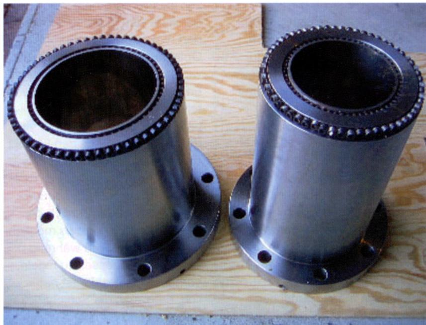
Bild 1: Außenringe von Rohrwerkzeugen zur Herstellung von Schaumkernrohren ( $\varnothing$  160 und 125 mm) mit integrierten Flexringhülsen, mit denen der Fließkanalspalt am Werkzeugaustritt über jeweils 60 Stellschrauben feinfühlig verstellt werden kann
